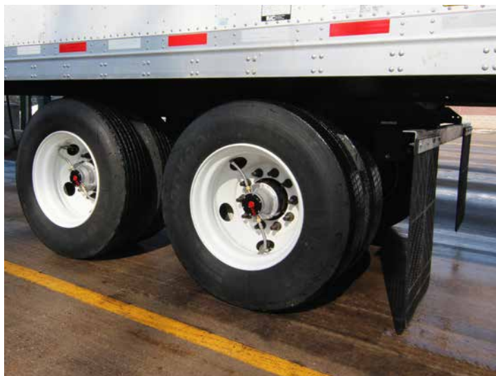
Ganz schön smart: Tire Pilot Plus™ hält jederzeit den optimalen Reifendruck aufrecht
